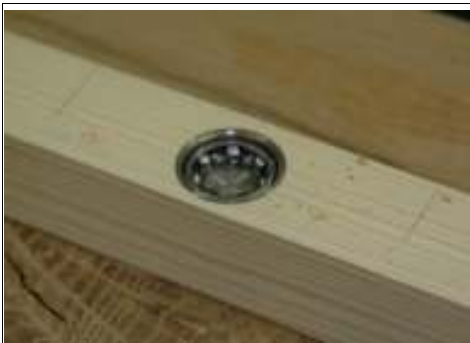
Abbildung 9: Kugellager für die Schwellerjalousien.
