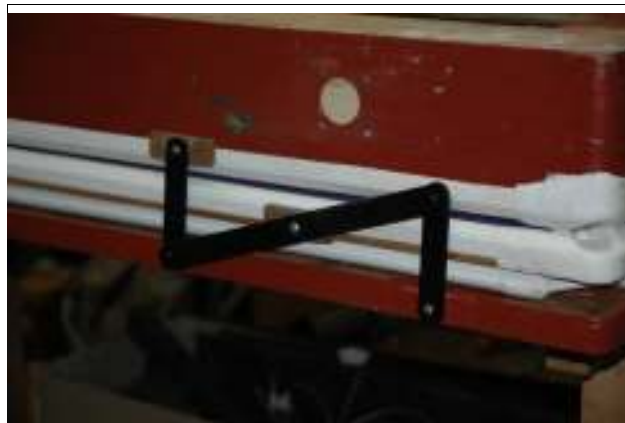
Abbildung 10: Eine neu belederte Balgecke in der Werkstatt. Zur Führung der Bewegung sind vier solcher Balgscheren montiert.
