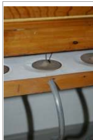
Abbildung 5: Detail der pneumatischen Tonsteuerung im Pedal.
