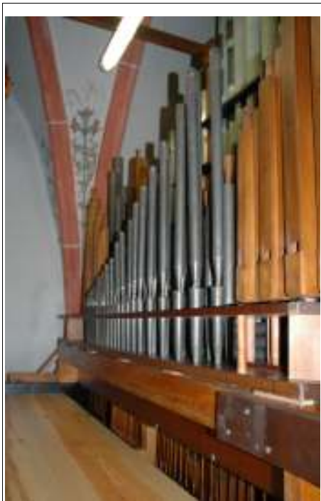
Abbildung 7: Blick auf die Pfeifen der Hauptwerkklade.
